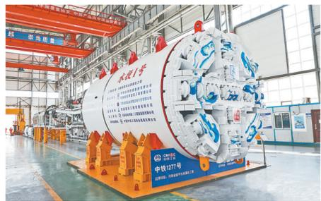
本报讯(记者 王译博 文图)昨日，“水投1号”双铰接复合式土压平衡盾构机在中铁装备郑州基地下线，该设备将应用在河南省前坪灌区北干管汝阳供水工程项目施工二标段，推动河南水利工程隧道施工向智能机械化掘进机工法快速转变。
