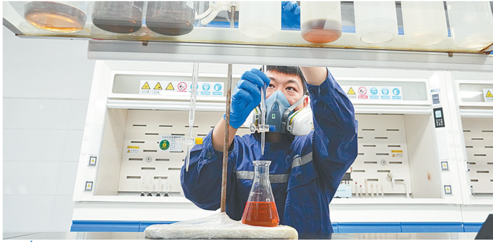
登封海中环保科技有限公司实验室工作人员对固体废物、危险废物等进行化验，以达到处理时配比科学
