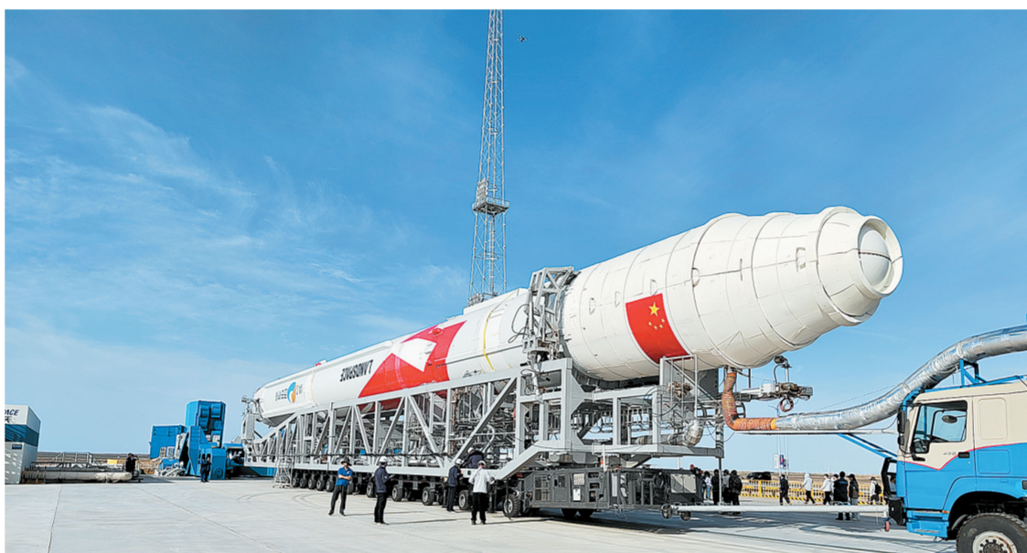
郑州新大方自主研发的DCY120型火箭专用运输车正在进行火箭的水平运输
