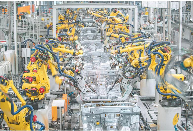
在长城汽车重庆永川生产基地焊装车间,智能化焊接机器人在进行焊接作业。
