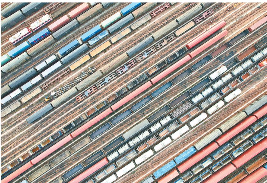
8月2日,亚洲最大的列车编组站——郑州北站内,铁路工人正在作业,将一列满载工程机械的列车进行编组。郑州铁路枢纽中的郑州北站,共有道岔898组、信号机828架、各种线路228条,线路总延长454公里。郑州北编组站主要承担着南北京广线、东西陇海线四个方向货物列车和郑州枢纽地区小运转列车的到达、解体、编组及出发作业任务,是名副其实的巨型“铁路编组核心,物流中转站”,也是亚洲最大的铁路枢纽编组站。郑报全媒体记者 周勇 摄
