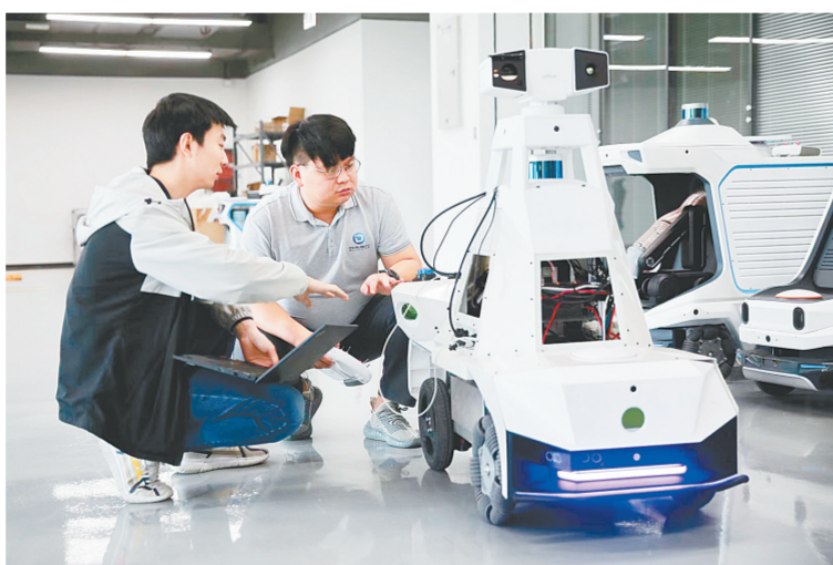
研发人员正在进行巡检机器人调试
