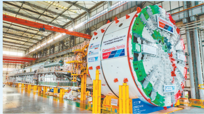
意大利萨拉诺高速铁路项目的“中国中铁1418号”土压平衡盾构机
