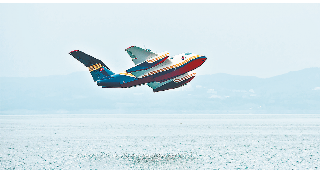
郑州海王实业有限公司自主研发制造的“海王一号”地效翼船进行海水试飞
